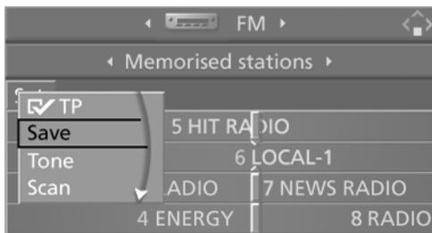
5. Поворотом контроллера выберите канал памяти. Номер канала появляется рядом с названием или частотой радиостанции.
