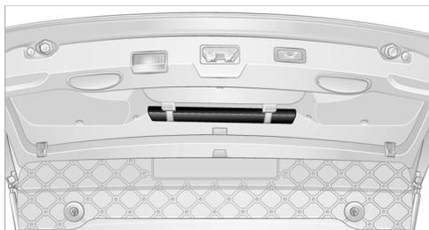
Откройте два фиксатора и опустите обшивку.
