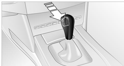
В коробке передач предусмотрена блокировка, которая препятствует случайному включению положений R и P. Чтобы снять блокировку, нажмите кнопку на передней стороне рычага селектора, см. стрелку.
