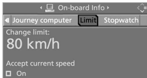
5. В зависимости от комплектации автомобиля выберите пункт „Change limit:“ (Изменить значение) или настройте значение скорости и нажмите на контроллер.
