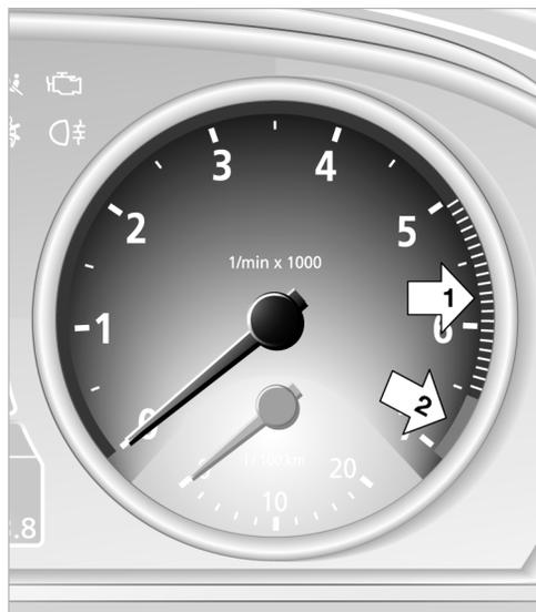
Предупреждающий сектор с белыми делениями, стрелка 1, изменяется в зависимости от температуры двигателя. С ростом температуры двигателя этот сектор уменьшается. Старайтесь не доводить обороты двигателя до значений предупреждающего сектора.
