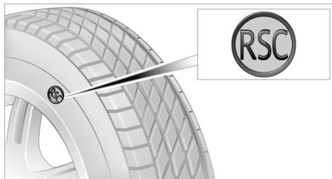
Шины, допускающие движение в аварийном режиме, можно узнать по круглому значку с надписью RSC на боковине. Колесо Runflat состоит из самонесущей шины и специального диска. Усиленные боковины позволяют, хотя и с ограничениями, продолжить движение даже на спущенной шине.
