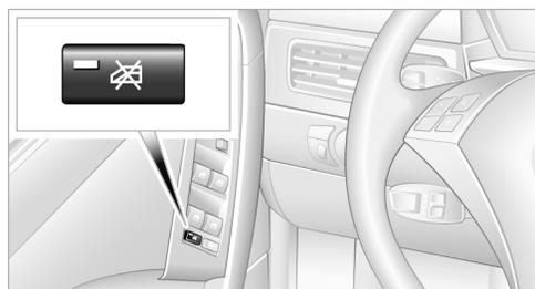
С помощью этого выключателя можно воспрепятствовать открыванию и закрыванию задних окон с помощью переключателей стеклоподъемников в задней части салона (например, детьми). Когда предохранительная функция включена, в выключателе горит светодиод.
