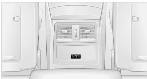
Гнездо для подключения наушников: разъем 3,5 мм.
