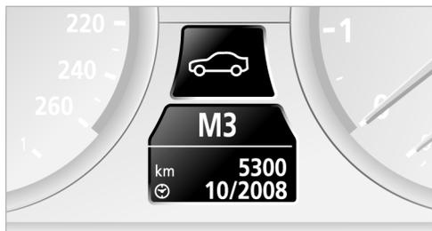
После поворота ключа зажигания в положение 2 в комбинации приборов высвечивается, когда и через сколько километров Вам предстоит пройти очередное техническое обслуживание.
