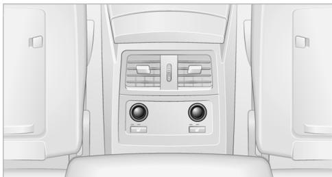
В зависимости от оснащения автомобиля розетки в задней части салона могут быть закрыты крышками или укомплектованы прикуривателем. См „Передний прикуриватель“ на странице 108.
