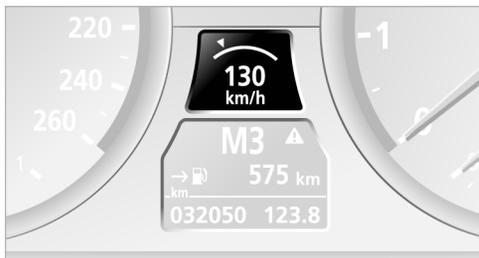
Нажмите переключатель от себя, см. стрелку 1 – текущая скорость заносится в память и отображается на спидометре и, кратковременно, в комбинации приборов. При повторном нажатии переключателя задаваемое значение будет округлено до десятков в сторону увеличения. С каждым последующим нажатием переключателя задаваемая скорость увеличивается еще на 10 км/ч.
