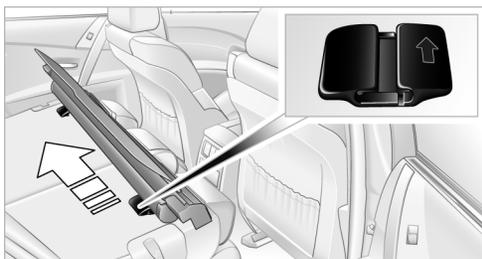
4. Вставьте втяжное устройство в направляющие на тыльной стороне задних спинок.
