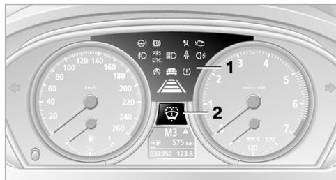
Контрольные и сигнальные лампы загораются отдельно и в различных комбинациях в секторе **1** и на дисплее **2**.
