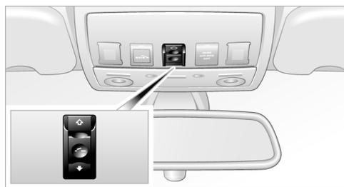
При ключе зажигания в положении 1 и выше, см. страницу 52, нажмите переключатель или сдвиньте его до точки срабатывания в требуемом направлении.
